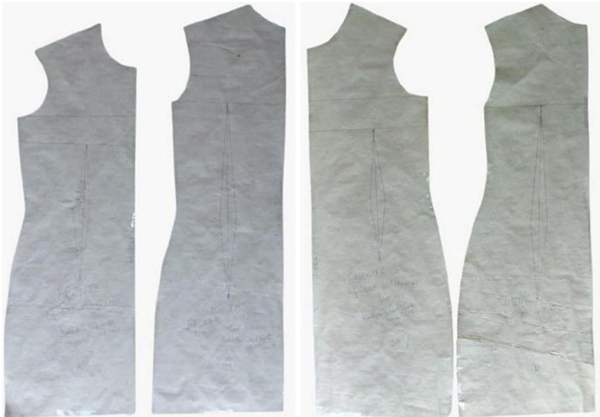
Figura 4 – Moldes dos vestidos a partir das NBR 13.377:1995 (esquerda) e NBR 16.933:2021 (direita)
