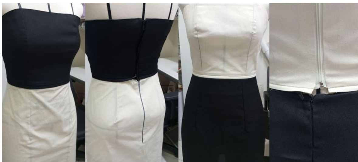
Figura 9 – Desalinhamento dos módulos causado por ausência de marcação interna
